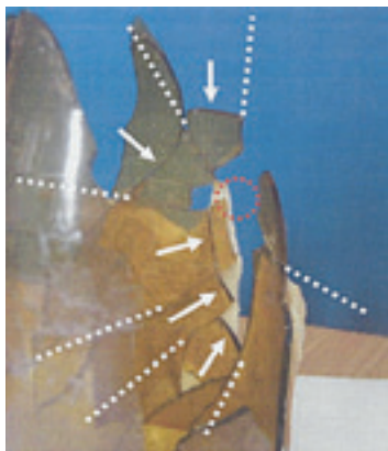
Bild 4: Bruchausgangspunkt – roter Kreis
